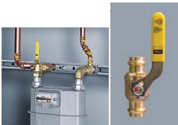
M2/5-8. ábra: Présidomos (réz anyagú) csatlakozó és fogyasztói vezeték esetén mérőkötés Viega alaplappal készíthető. Ha a mérőkötés az 1. melléklet 2.2 pontja szerinti geometriája másként nem biztosítható, akkor az alaplapot Viega gyári tartozékokkal (sarokcsap, vagy a gázmérő elé épített átmenő csap, könyök) kell szerelni. A toldat, vagy kiegyenlítő toldat és a hollandik már a FŐGÁZ Földgázelosztási Kft-nél rendszeresített idomok legyenek.
